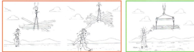
Slika 3: Nevarno in varno dviganje bremen
