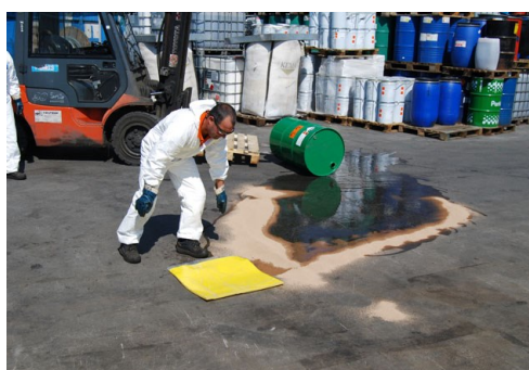
Tekočino se posuje s praškom, ki veže nase nevarno tekočino
